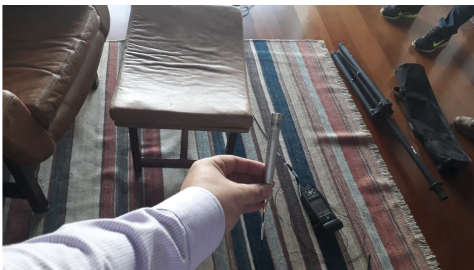
Figura 6.1: Microfone de medição usado no recinto interno.
