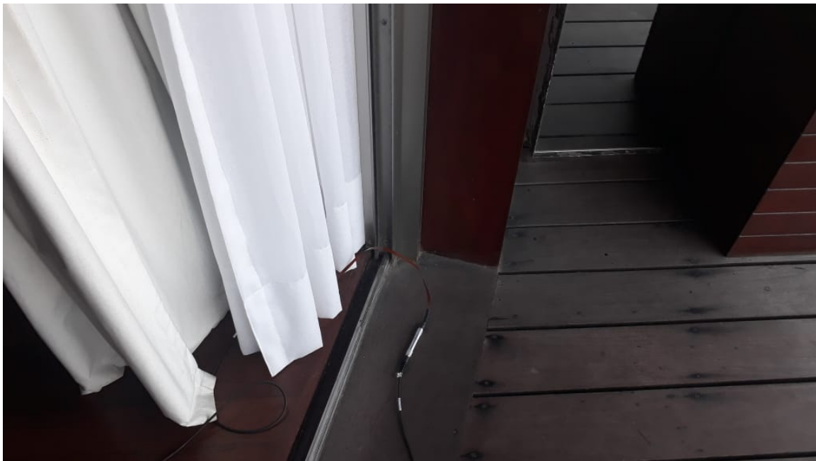
Figura 6.6: Cabo passaporta utilizado para medir com os dois microfones simultaneamente.
