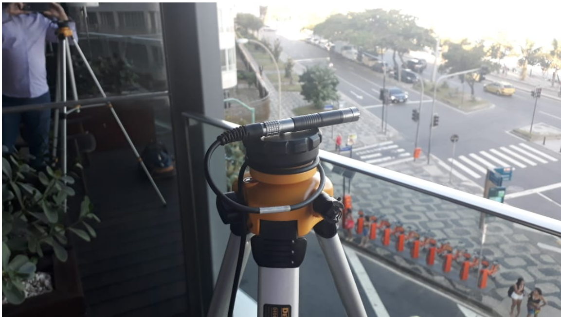
Figura 6.2: Microfone de medição usado no recinto externo.
